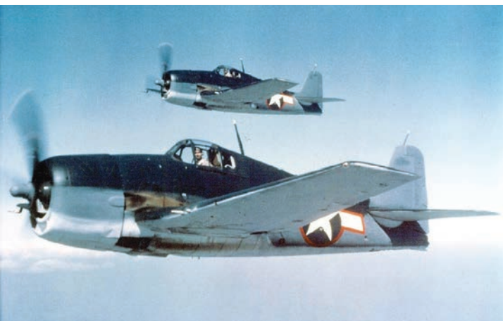
Deux chasseurs Grumman F6F-3 arborant le camouflage tricolore (bleu marine, bleu intermédiaire et blanc insigne), mai 1943.
