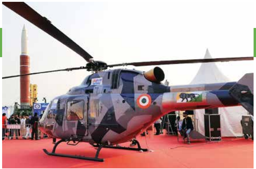
▲ Le LUH est un hélicoptère utilitaire léger multirôle de classe 3 tonnes, d'une charge utile de 400 kg et d'une autonomie de 350 km. (Photo IAF)
